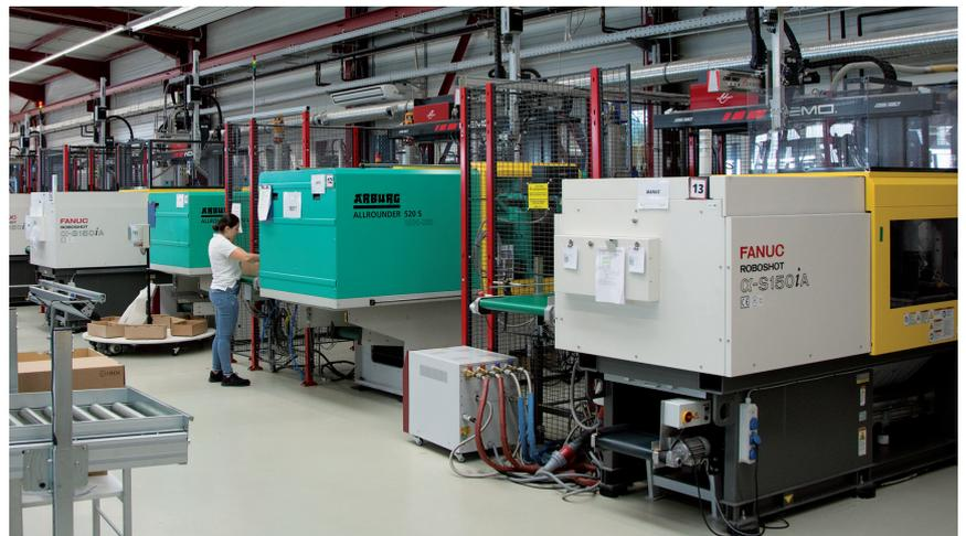
Produktionshalle mit neuen Spritzgussmaschinen. (Foto: IMOS Gubela GmbH)
