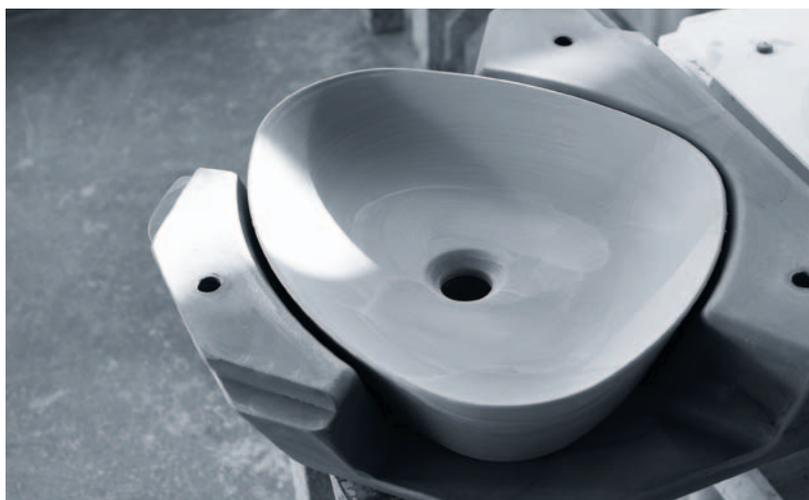
Rohling bei der Entformung, Bild unten: Fertige Waschschale, glasiert und gebrannt
