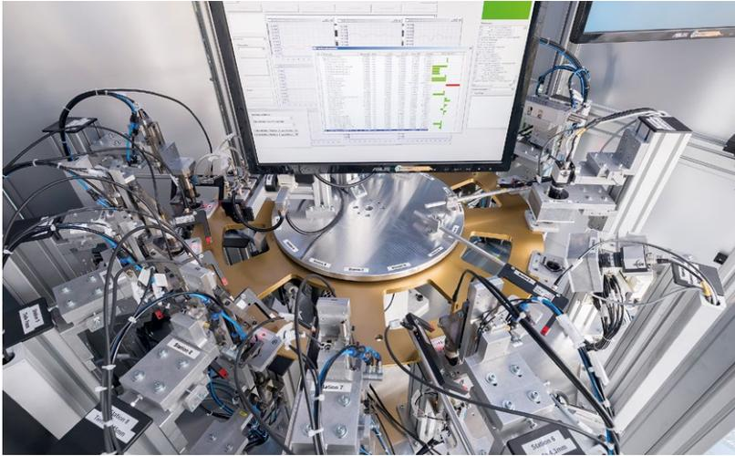
Automatisierte 100 %-Prüfung
