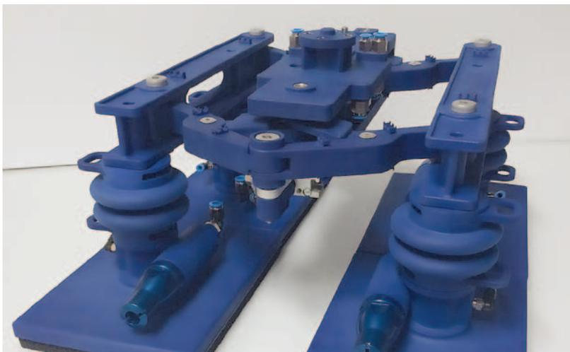
Umsetzgreifer für Verpackungen mit Spreizhub
