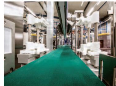
Zentriereinheiten in einer Etikettiermaschine
