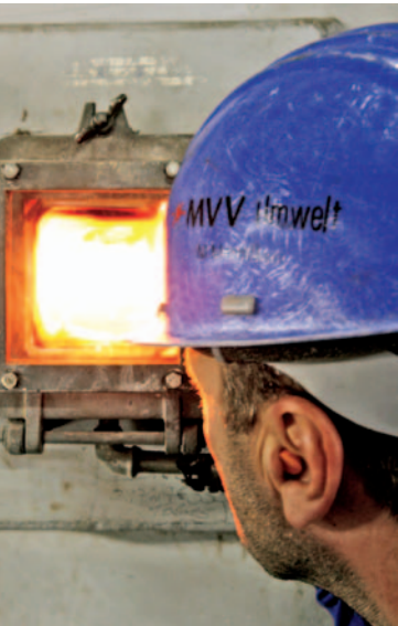
Im HKW verbrennt Abfall bei 850 bis 1.000 °C.
