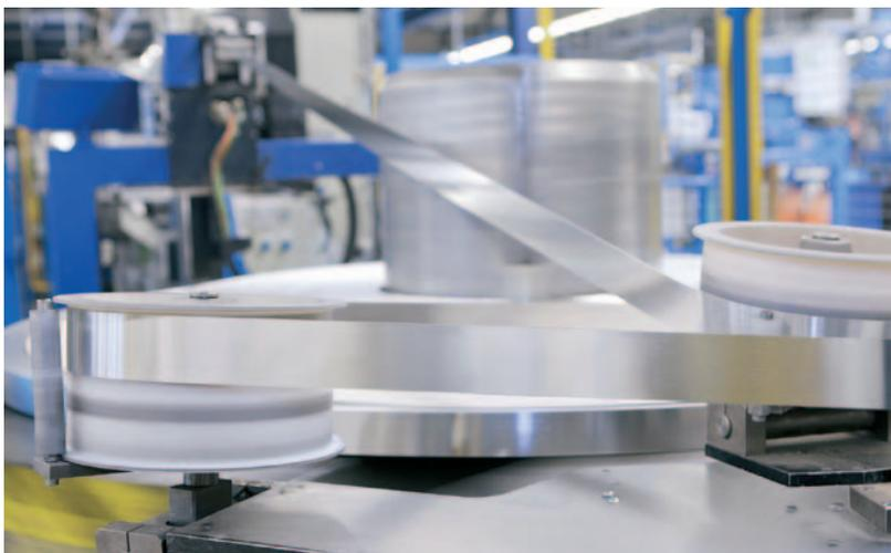
Putzprofile werden aus Bandstahl hergestellt
