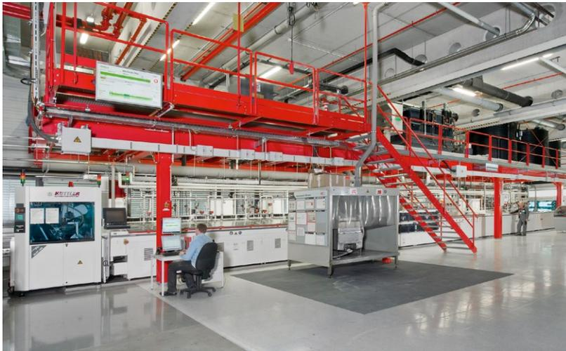
Alkalische Ätzlinie mit der Recyclinganlage auf der Bühne
