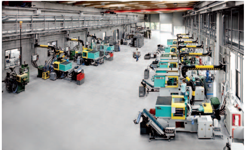
Neue Kunststofffertigung mit Medienstegen
