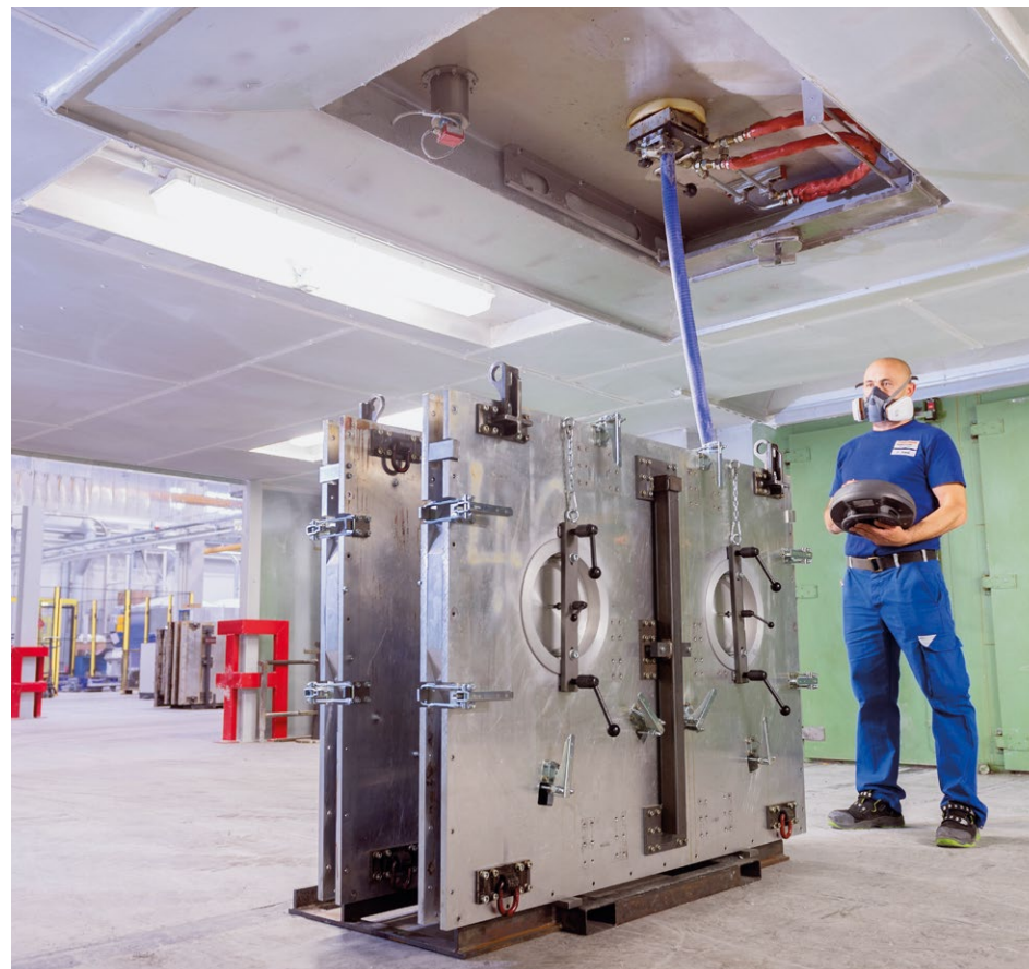
Abguss eines PA12-Gusshalbzeugs in der Gießerei
