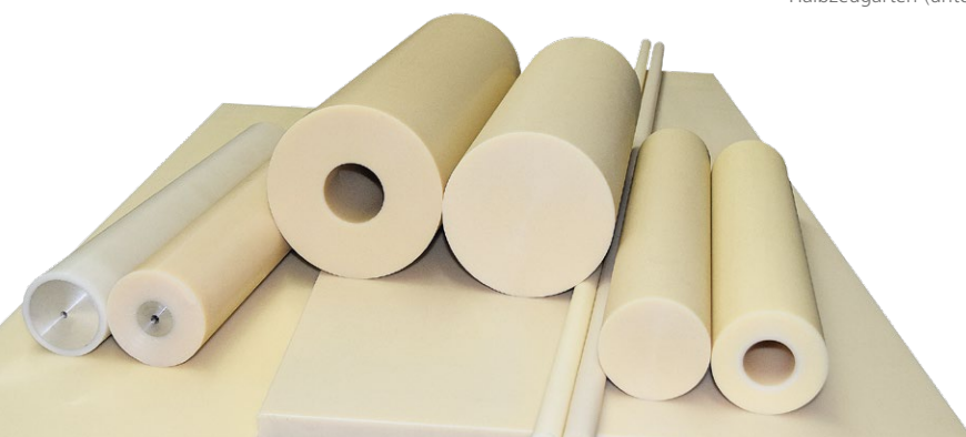
PA12-Filament hergestellt aus PA12-Gussspänen (oben) Standard PA12-Halbzeugarten (unten)
