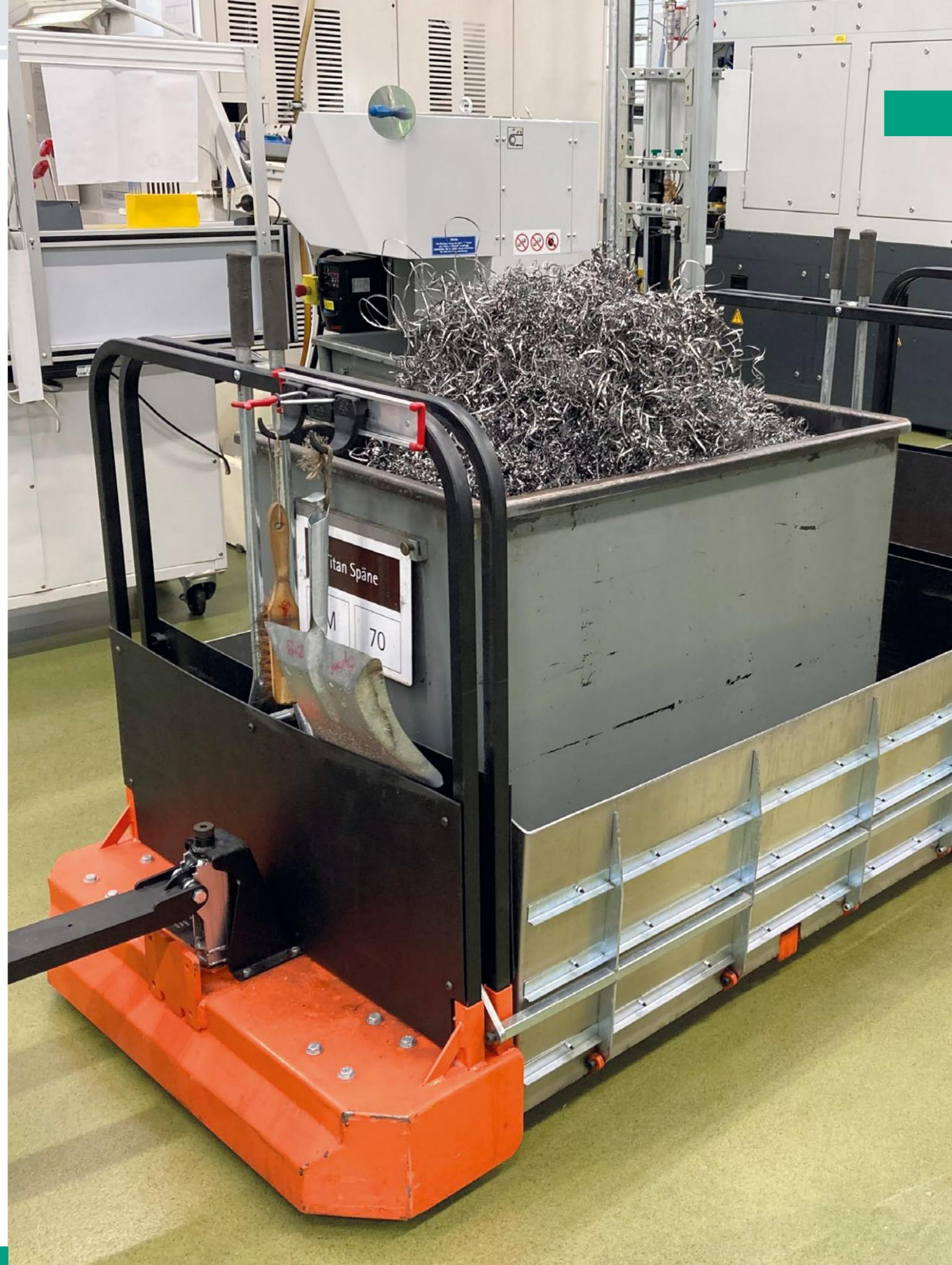
Edelstahl sortiert. Für die sortenreine Trennung der Spänefraktionen sind die einzelnen Abteilungen verantwortlich. Die Spänekübel werden mittels eines Spänezugs aus der Fertigung an eine zentrale Sammelstelle gebracht. Von dort werden sie mit Staplern zur Schredderanlage, bestehend aus vier Schredder-Einzelanlagen, transportiert.
