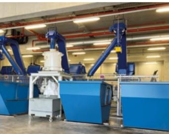
Metallspäne-Schredderanlage bestehend aus mehreren Einzelanlagen
