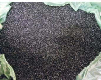
PA12-Regranulat hergestellt aus PA12-Gussspänen
