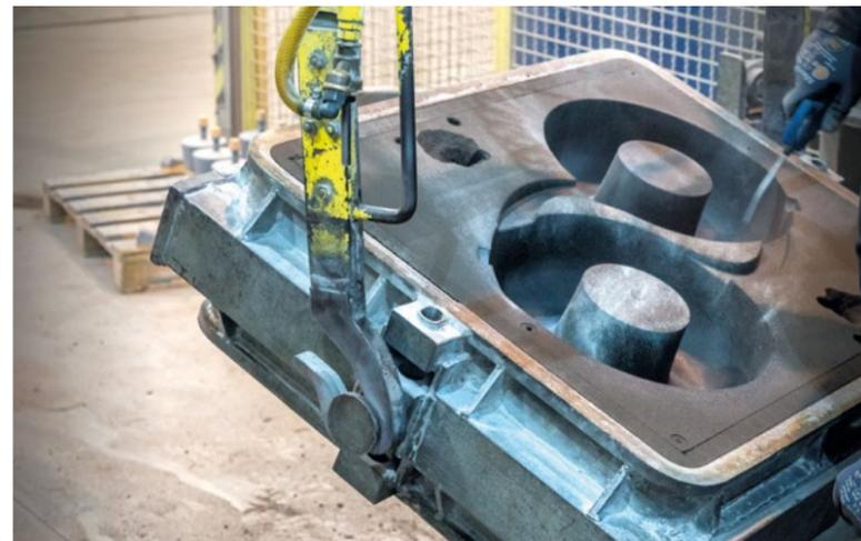
Maschinelle Formherstellung auf einer Formanlage
