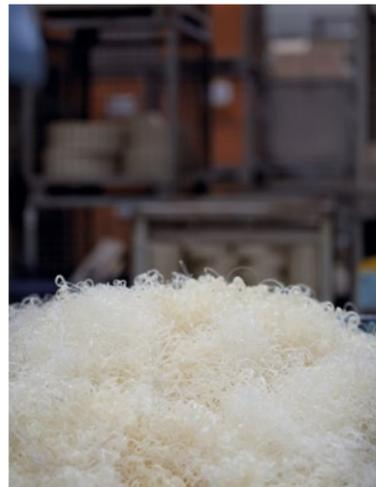
In der mechanischen Fertigung anfallende PA12-Guss-späne
