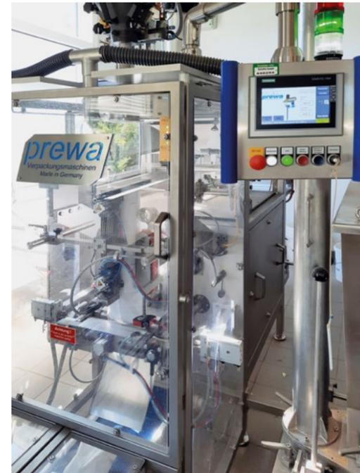
Automatische Abfüllung der Beutel in der neuen Anlage
