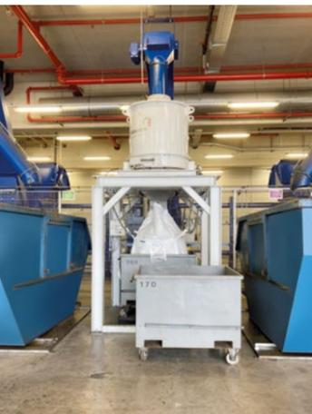
Schredderanlage mit Zentrifuge zur Abtrennung von KSS
