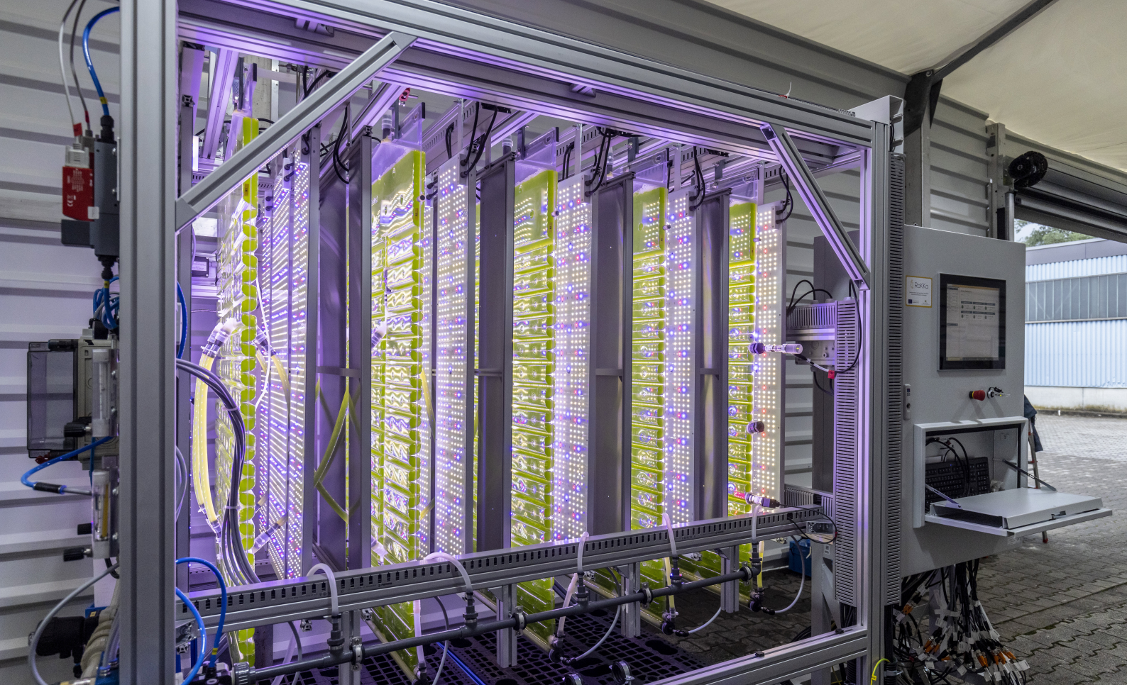
In dieser Pilotanlage stellt die Mikroalge Phaeodactylum tricoratum das hochmolekulare Polysaccharid Beta-Glucan aus Kohlenstoffdioxid, das aus dem Faulgas der Kläranlage Erbach (Donau) stammt, mithilfe von Licht bei optimalen Wellenlängen her. Das Fraunhofer-Institut für Grenzflächen- und Bioverfahrenstechnik IGB aus Stuttgart betreut die Pilotanlage. Foto: Frank Eppler
