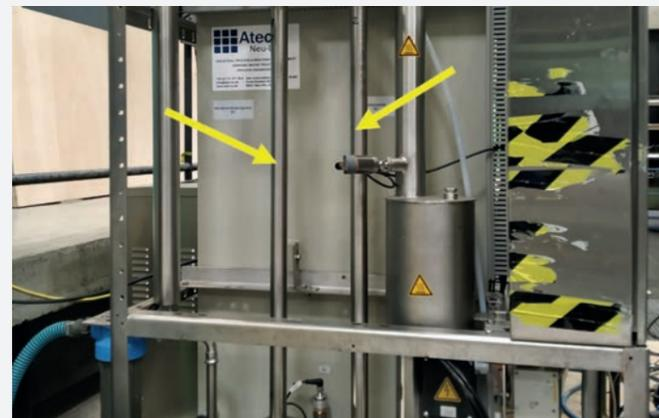
Abb. 2: Querstrom-Mikrofiltration mit Keramikmembranen (Röhren mit Membranen mit Pfeilen gekennzeichnet; Länge je 1 m, Porengröße 0,2 µm); Anlage Atec, Ulm.
