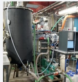
Abb. 1, links: Batch-Reaktoren (ampts2<sup>®</sup>) im Labormaßstab mit einem Volumen von 2 L. Abb. 2, mitte: 40 L halbkontinuierlicher Reaktor. Abb. 3, rechts: 300 L halbkontinuierlicher Reaktor im Pilotmaßstab, gekoppelt mit einem Vorklärrichter.
