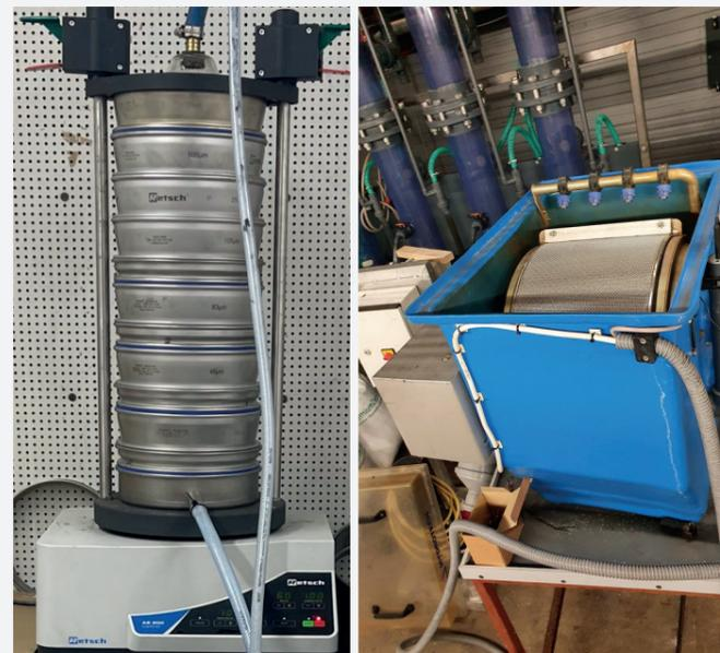
Abb. 2, links: Nasssiebkolonne. Abb. 3, rechts: Halbtechnische Mikrosiebtrommel.
