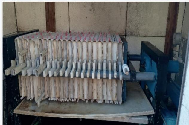
Abb. 1: Kammerfilterpresse mit mehreren Kammern (Filtertücher mit 100 µm Maschenweite).
