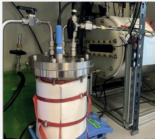
Abb. 2: Bioelektrochemischer 10-L-Drehscheibenreaktor.
