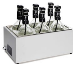
Abbildung 12. Batch-Reaktoren (ampts 2 ) im Labormaßstab mit einem Volumen von 2 L.
