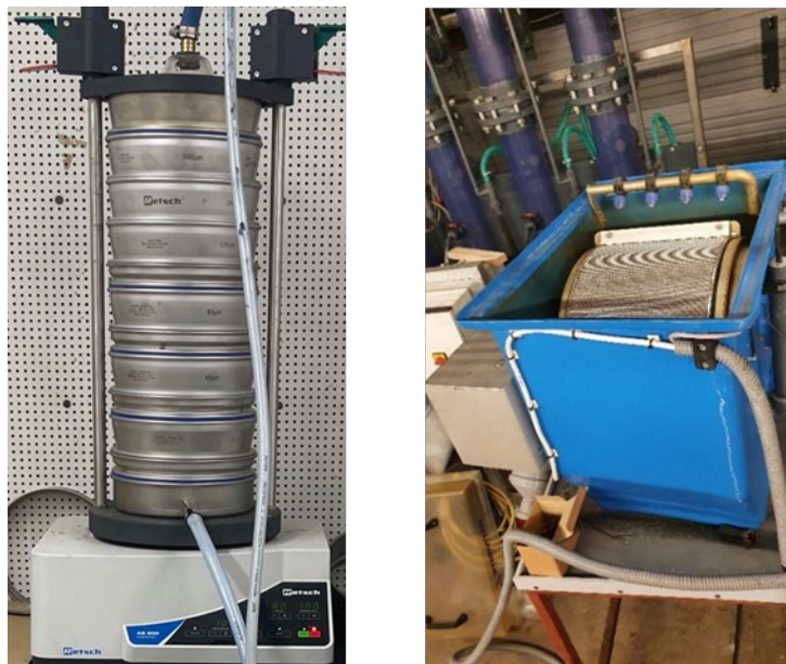
Abbildung 1. Nasssiebkolonne (links), halbtechnische Mikrosiebtrommel (rechts)
