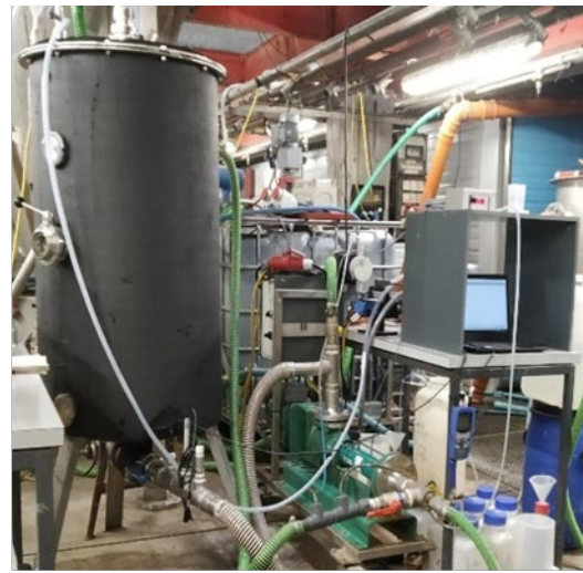
Abbildung 13. Links: halbkontinuierlich betriebener 40-L-Reaktor; rechts: halbkontinuierlich betriebener 300-L-Reaktor im Pilotmaßstab, gekoppelt mit einem Vorklärtrichter.
