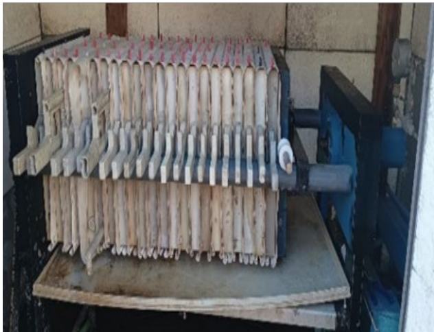
Abbildung 15. Kammerfilterpresse mit mehreren Kammern (Filtertücher mit 100 µm Maschenweite) (links); Querstrom-Mikrofiltration mit Keramikmembranen (Röhren mit Membranen mit Pfeilen gekennzeichnet; Länge je 1 m, Porengröße 0,2 µm) (rechts).
