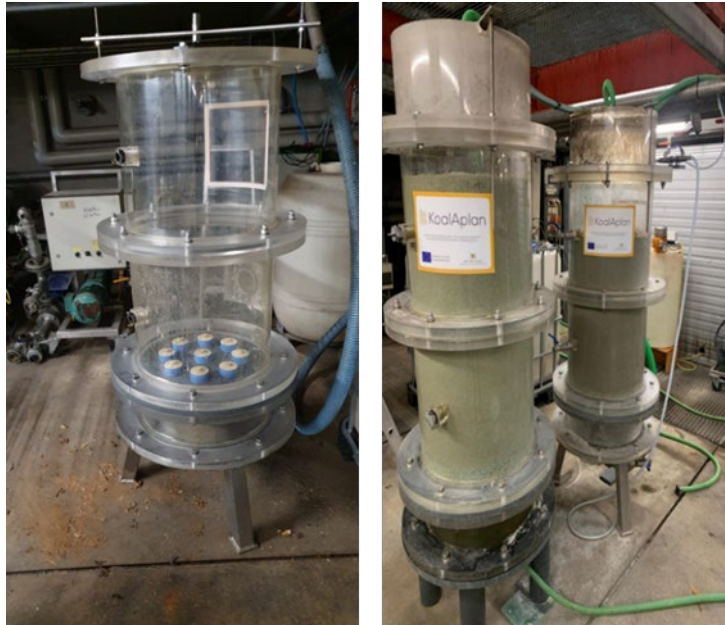
Abbildung 9. Halbtechnische Ionenaustauscherkolonne (links leer, rechts gefüllt)
